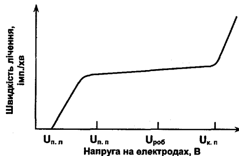
Рис. 5.7. Лічильна характеристика лічильника: U_{п.л} – напруга початку лічення; U_{п.п} – напруга на початку плато; U_{роб} – робоча напруга; U_{к.п} – напруга в кінці плато
